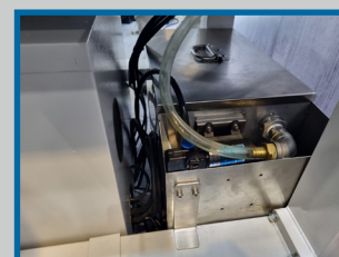
Système de refroidissement liquide de la broche
