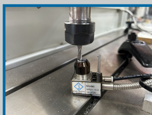
Electro-broche 24 000 tr/min + palpeur d'outil
