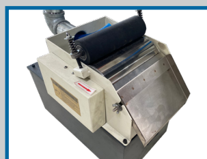
Bac arrosage + séparateur magnétique
